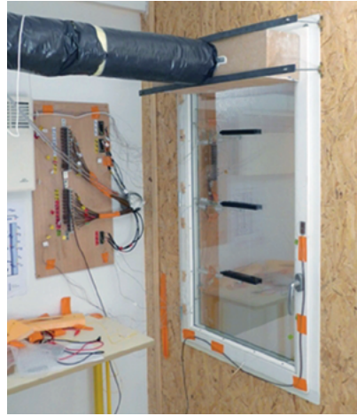
Instrumentation of an experimental window at the Faculty of Applied Science of University of Artois in Béthune. Instrumentation à la Faculté des Sciences Appliquées de l'université d'Artois à Béthune.
